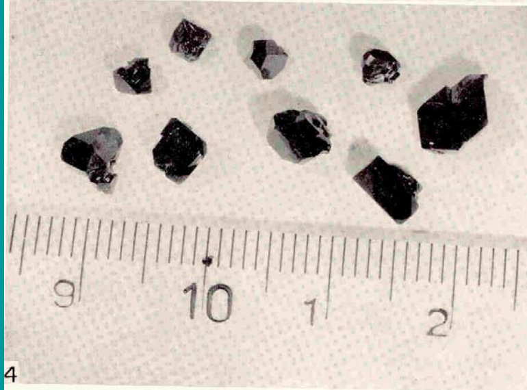
ABB. 3. Auf Platindraht aufgewachsene Nickel-Chlor-Borazitkristalle (Masstab in cm). Der Draht tauchte in die flüssige Borsäure ein.
